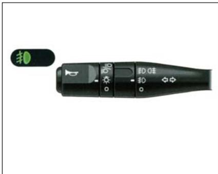
**ПЕРЕДНИЕ ПРОТИВОТУМАННЫЕ ФАРЫ:** чтобы их включить поверните вперёд средний кольцевой выключатель. Одновременно с включением противотуманных фар на приборной панели загорается соответствующий индикатор. Эти фары можно зажечь и тогда, когда включены обычные фары или габаритные огни.
