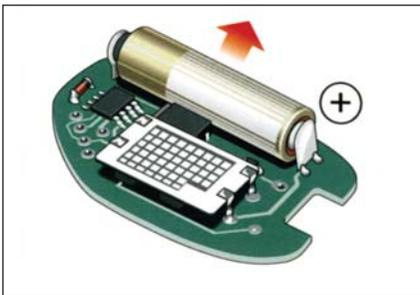
Вытащите разряженную батарейку и замените её свежей. Используйте батарею 27A/12 вольт. Поставьте крышку на место и заверните отвёрткой винт. **ЗАПОМНИТЕ,** что даже при полностью разряженной батарее центральный замок будет действовать, если открывать дверь водителя ключом. Тем не менее не пользуйтесь долго пультом с разряженной батареей.
