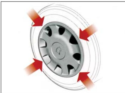
Приложите колпак к колесу и сильно надавите, чтобы он сел на место. Поместите ящик с инструментами на его место в багажном отсеке, туда же поместите заменённое колесо и затяните удерживающий колесо ремешок.
