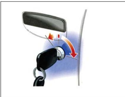
**ОТПИРАНИЕ ЗАМКОВ ВРУЧНУЮ С ПОМОЩЬЮ КЛЮЧА:** используйте ключ для централизованного отпирания или запираения вручную дверей и багажника. Вставьте ключ в замок двери со стороны водителя и поверните его влево, если хотите запереть замок двери или вправо - если хотите открыть. Он задействует замки всех дверей, крышки багажника и лючка бензобака.
