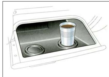
Дверца перчаточного ящика оборудована гнездами для двух стаканов. Будьте внимательны, чтобы не захлопнуть дверцу, когда там стоят стаканы. Также следите за стаканами и их содержимым при движении автомобиля.
