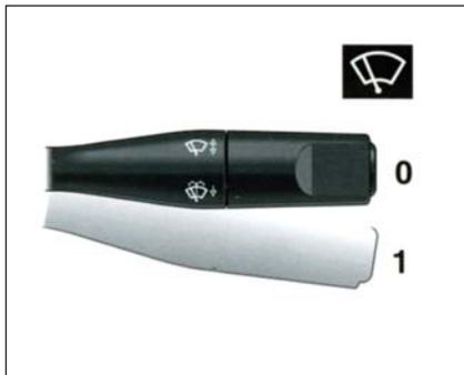
**ВКЛЮЧЕНИЕ СТЕКЛООЧИСТИТЕЛЯ НА ОДИН ЦИКЛ** ( движение "дворника" туда и обратно ) для этого следует нажать рычаг один раз вниз. Если вы потяните рычаг на себя, начнёт работать омыватель стекла.
