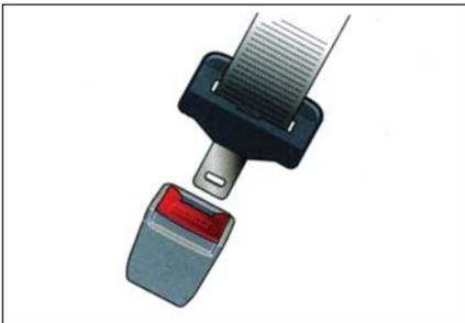
**ЗАСТЁГИВАНИЕ РЕМНЯ:** плавно потяните ремень через ключицу и грудь и проверьте, чтобы ремень не перекрутился. Вставьте металлический язычок ремня в замок до характерного щелчка и удостоверьтесь, что он защёлкнулся.
