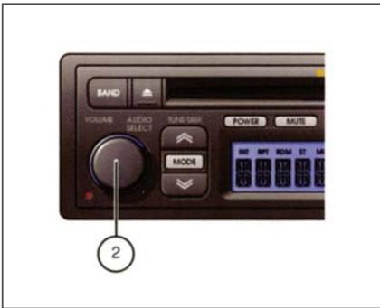
**РЕГУЛИРОВКА БАСОВ:** нажатием кнопки 2 выберите положение **BASS**, затем вращением этой кнопки можете выбрать для себя нужный вам уровень низких тонов в звучании магнитолы вашего автомобиля.
