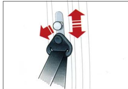
**РЕГУЛИРОВКА РЕМНЕЙ ПЕРЕДНИХ КРЕСЕЛ ПО ВЫСОТЕ:** оттяните наружу рычажок регулятора высоты ремня ( см. рисунок ) и поднимите или опустите на одну или несколько ступеней по вашему выбору.
