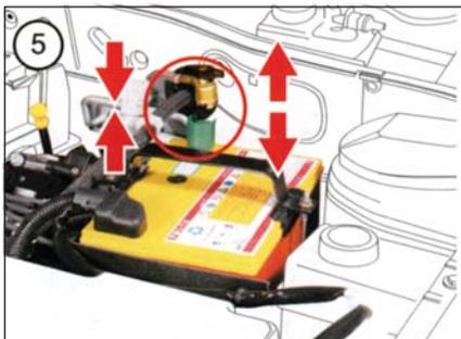
Для перенастройки необходимо отсоединить аккумуляторную батарею и коннектор тревожной сирены, а затем снова включить. Вы можете отключить тревожную сирену при помощи специального ключа, прилагаемого в комплекте ключей автомобиля.
