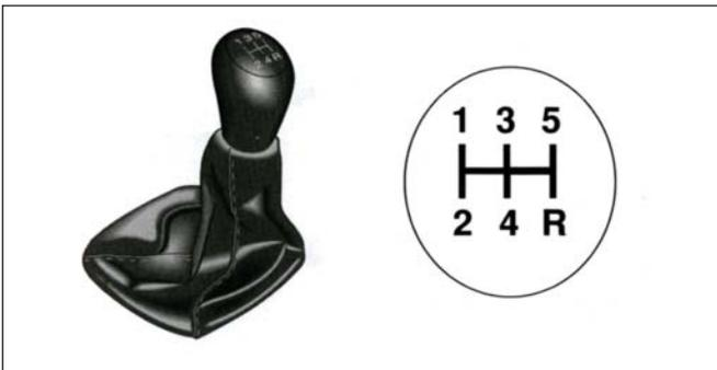
**ПОЛОЖЕНИЯ РЫЧАГА КОРОБКИ ПЕРЕДАЧ:** схема переключения передач изображена на рукоятке соответствующего рычага. Коробка передач синхронизирована со всеми передачами, включая передачу заднего хода. **НЕСКОЛЬКО СОВЕТОВ ОТНОСИТЕЛЬНО ПЕРЕКЛЮЧЕНИЯ ПЕРЕДАЧ:**
