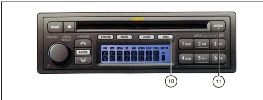
**ЗАПОМИНАНИЕ ВЫБРАННЫХ РАДИОСТАНЦИЙ.** Нажмите кнопку **BSM** для выбора радиостанций. Каждая из них будет звучать 5 секунд. В диапазоне AM можно будет запомнить 6 радиостанций, в диапазонах FM - 18 радиостанций. На дисплее автомагнитолы будут высвечиваться в мигающем режиме порядковый номер каждой станции диапазона. Выбранную вами радиостанцию можно занести в память системы нажатием кнопки **BSM** в время демонстрационного звучания.
