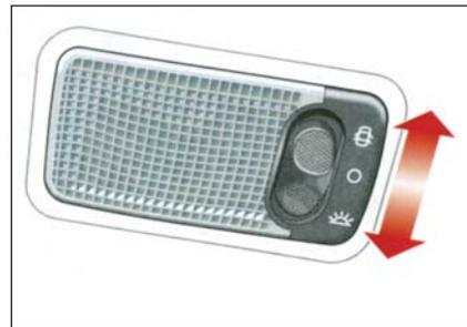
**ЗАДНИЙ ПЛАФОН:** этот источник света загорается при каждом открывании передней или задней двери, а также может гореть постоянно. После закрытия двери плафон горит ещё около 15 секунд, затем гаснет. (На выключатели плафона три положения, такие же, как и на переднем плафоне ).
