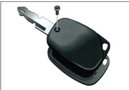
**ЗАМЕНА БАТАРЕЙКИ НА ПАНЕЛИ ДИСТАНЦИОННОГО УПРАВЛЕНИЯ:** если перестаёт мигать лампочка на блоке дистанционного управления или он начинает давать сбой - значит необходимо заменить батарейку. Для этого: Отвёрткой отвинтите винт на обратной стороне панели дистанционного управления и откройте крышку.
