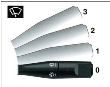
**СТЕКЛООЧИСТИТЕЛЬ:** рычаг стеклоочистителя и омывателя стекла расположен на правой стороне рулевой колонки и работает только при включённом зажигании в следующих режимах:
